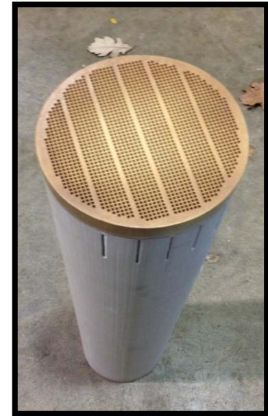
Ceramic membrane module for AnMBR
